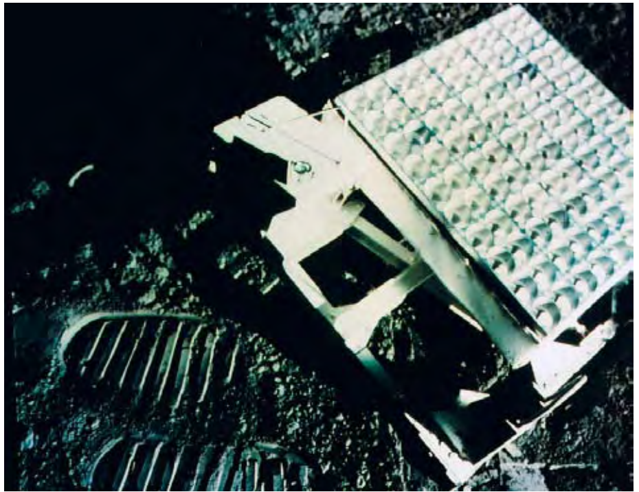
So klein ist der Laserreflektor, der von APOLLO-Astronauten „auf dem Mond“ aufgestellt wurde. Daneben zum Größenvergleich Schuhabdrücke eines Astronauten.
