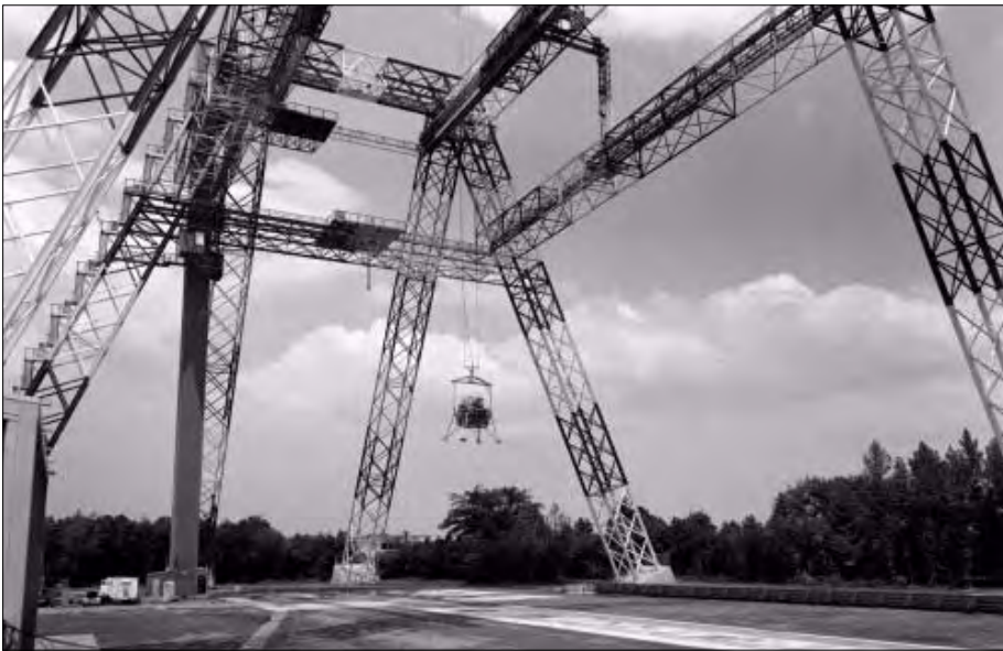
An solchen Ausleger-Kränen hingen die APOLLO-Astronauten im Langley-Research-Zentrum an Gummiseilen, um eine Sechstel-Schwerkraft zu simulieren.
