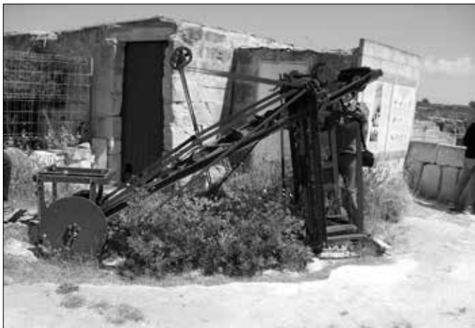
Eine der alten Steinschneidemaschinen, die heute vor sich hin rosten. Rechts erkennt man oben die Steinsägen.
