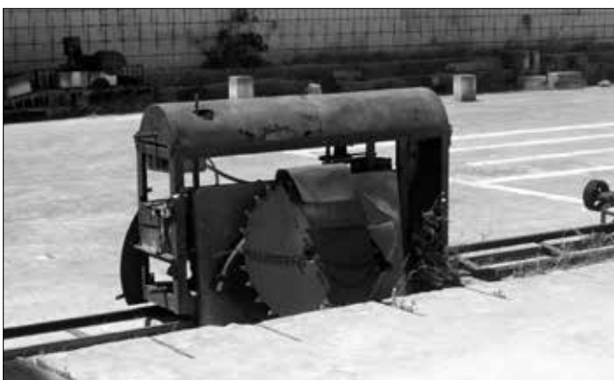
Eine andere alte Steinschneidemaschine, sie arbeitete mit rotierenden Sägeblättern, die mit speziell gehärteten Zähnen ausgerüstet war (rechtes Bild). Diese Maschine wurde über Schienen an die Felswand herangefahren.
