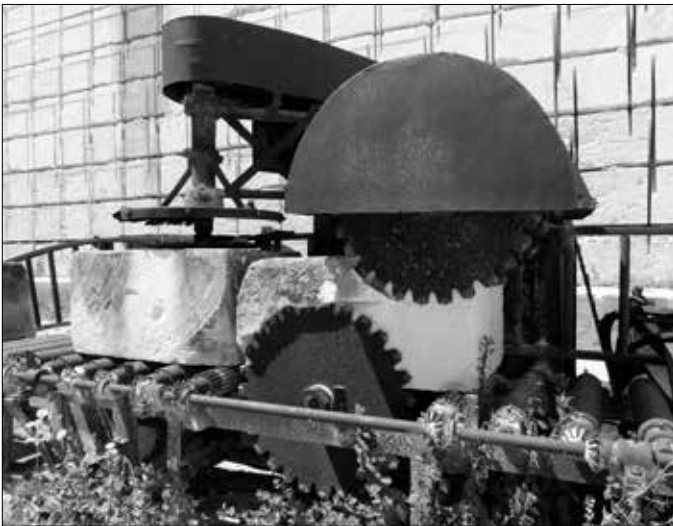
Eine dritte Steinschneidemaschine. Hiermit wurden die Steinblöcke in gleichmäßige Quader verarbeitet.
