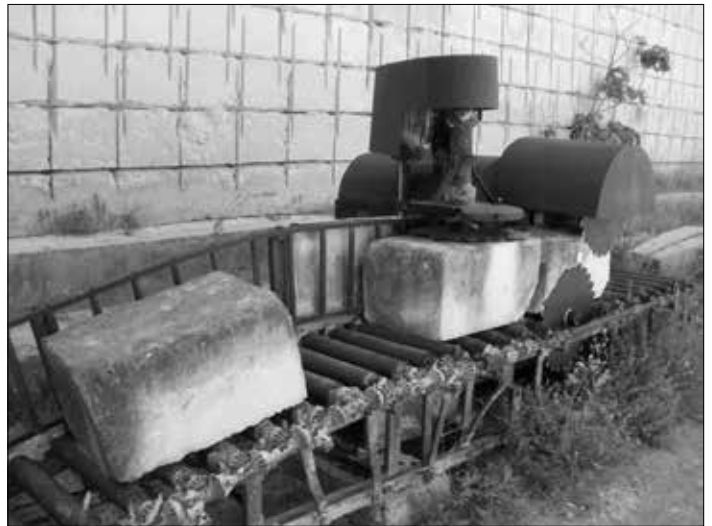
Eine dritte Steinschneidemaschine. Hiermit wurden die Steinblöcke in gleichmäßige Quader verarbeitet.
