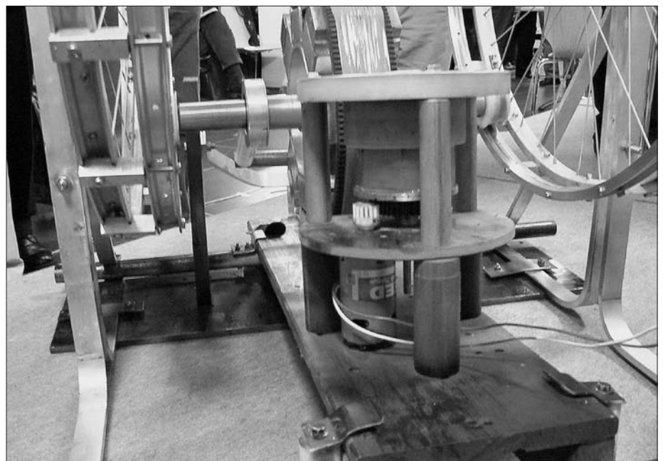
Abb. 7: Der Drehzylinder mit Antriebsmotor
